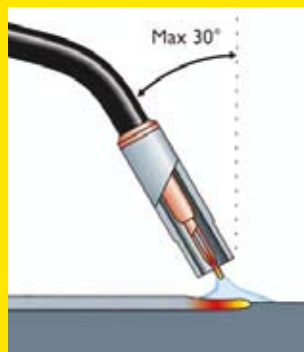
Luta inte svetspistolen för kraftigt – luft kan sugas in i gasskyddet genom elektroverkan. Använd rätt gasflöde. För högt flöde skapar ett oroligt gasskydd och för lågt flöde räcker inte till för att skydda både ljusbåge och svetsmälta.
