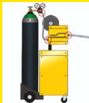
Undvik onödigt långa och grova slangar. Se till att de är oskadade och att alla kopplingar är täta.
