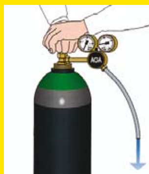
Låt gasen spola genom regulator och slang innan arbetet påbörjas.
