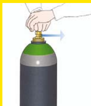
Blås ren flaskventilen innan regulatorn monteras.
