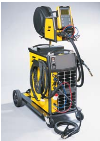
Figur 8. Exempel på strömkälla – AristoMig 500 med AristoFeed och U8-panel.
