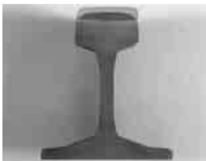
Räl av kol/manganstål: OK Tubrodur 15.43.
