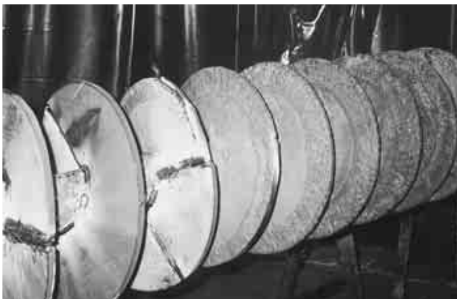
Matarskruv: Hårdsvetsning med OK Tubrodur 14.70.
