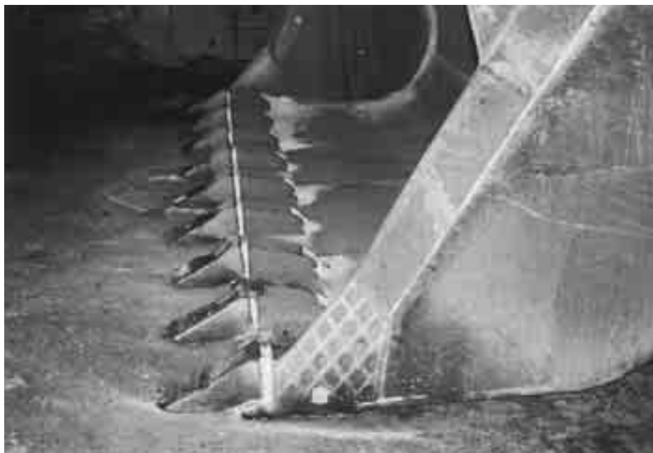
Förebyggande hårdsvetsning med OK 84.58.
