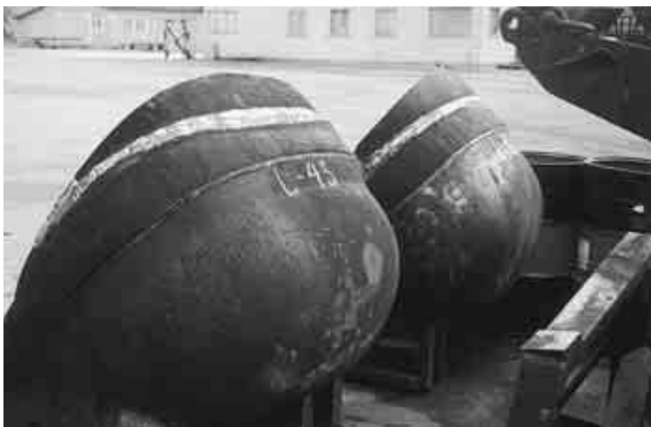
Skovel till mudderverk. Skarvsvetsning av ny grävläpp med elektroden OK 68.82.
