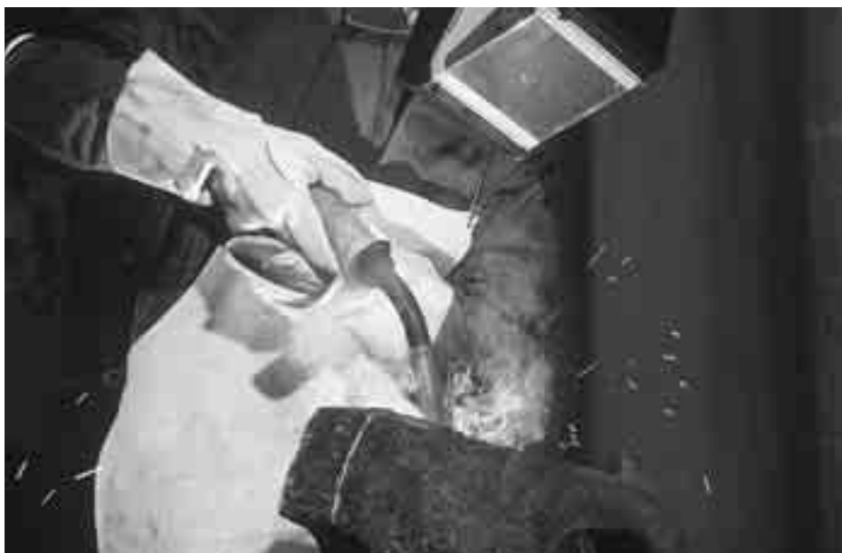
Krosshammare påsvetsad med OK Tubrodur 15.65.
