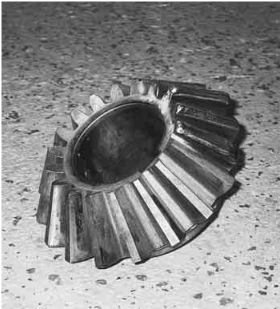
Kugghjul oppbyggt med elektroden OK 68.82.
