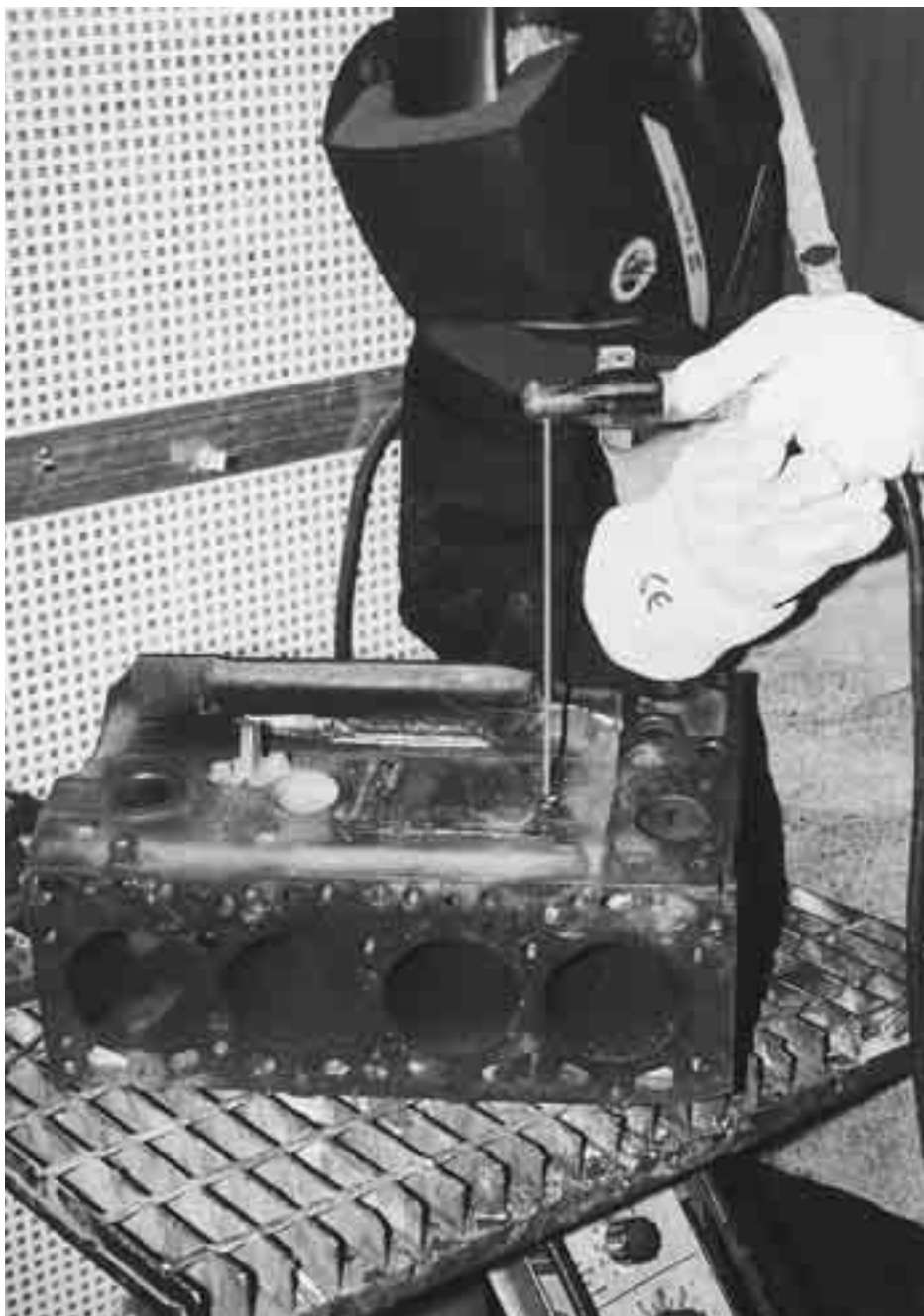
Motorblock. Reparation av gjutjärn med OK 92.18 och OK 92.60.
