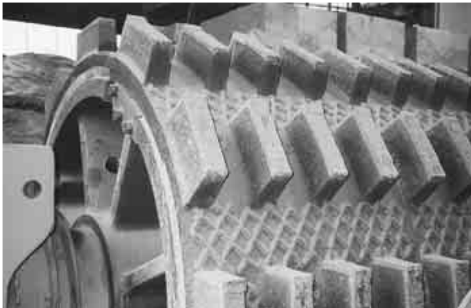
Krosständer: Buffertlager med OK 86.20, hårdsvetsning med OK 84.78. Rutmönster svetsat med OK Tubrodur 14.70.
